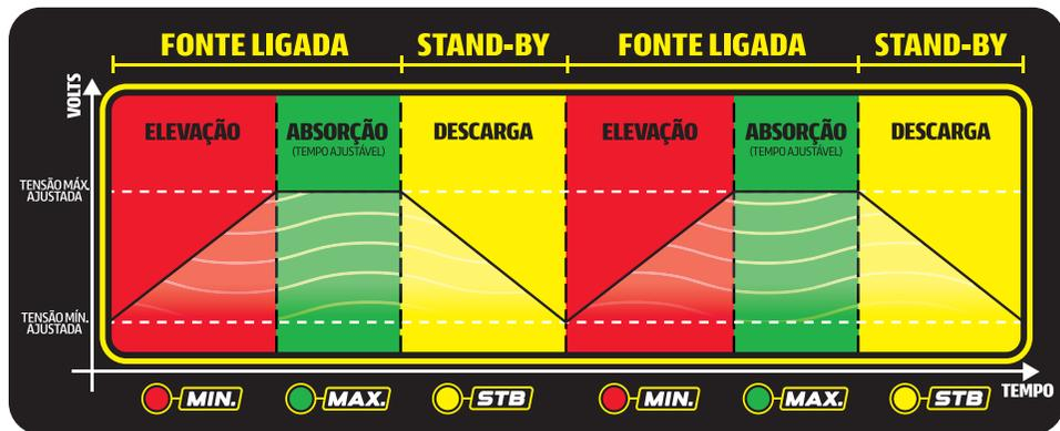
O gráfico acima exemplifica o funcionamento do modo LITHIUM/SOLAR, nele é possível ajustar a tensão máx. de carga, o tempo de absorção final e a tensão mín. de operação da(s) bateria(s). A fonte ficará em um looping infinito nos valores ajustados enquanto permanecer ligada.
