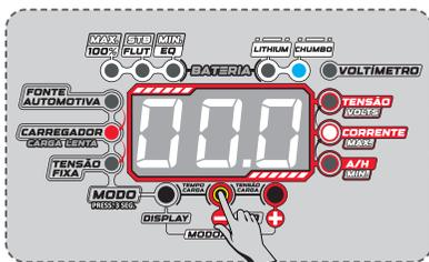
Após alterar para o modo carregador, altere entre os botões + e - para selecionar a corrente de carga
