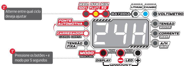
Volte para as configurações de fábrica com a função **RESET**. Pressione os botões **MODU**, **-** e **+** por 10 segundos, o display acenderá todos os LED's indicando que as configurações foram restauradas.
